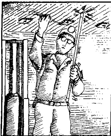
شکل ۷-۱۷- یک معدن‌چی در حین آزمایش سقف
