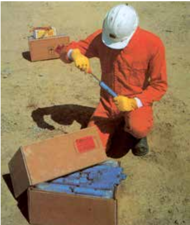
شکل ۹-۱۶- نحوه سوراخ نمودن دینامیت با درفش
