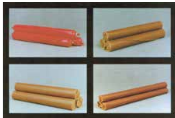
شکل ۵-۱۶- دینامیت و انواع آن
