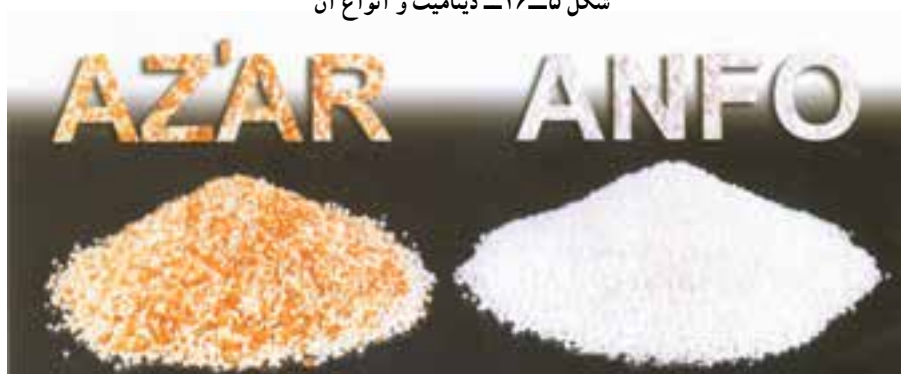
شکل ۶-۱۶- پودر آنفو و پودر آذر
