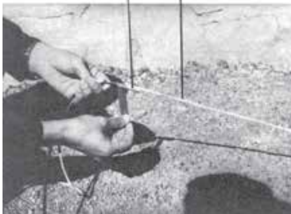
شکل ۱۶-۱۶- نحوه‌ی اتصال چاشنی به فیتیله با نوار چسب
