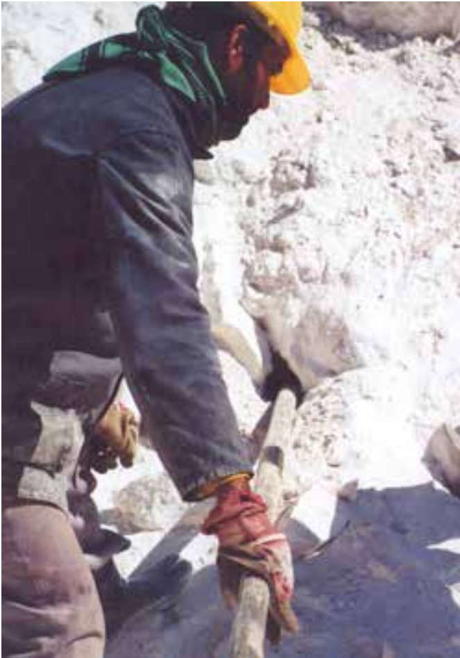
شکل ۳-۱۶- مراحل کار با سنبه چوبی
