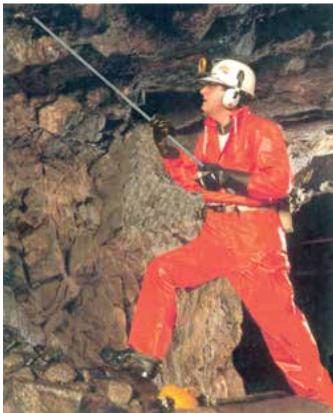
شکل ۲-۱۷- انجام لق‌گیری توسط کارگر
