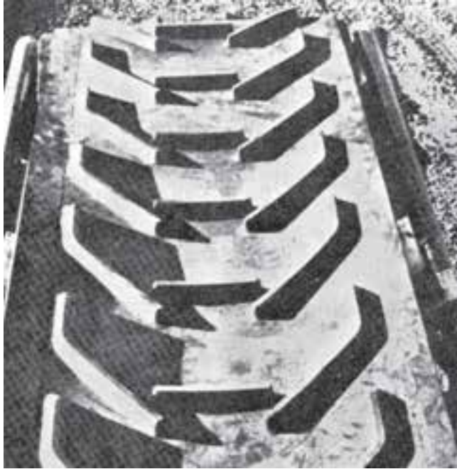
شکل ۱۱-۱۳- نوار با سطح آج دار
