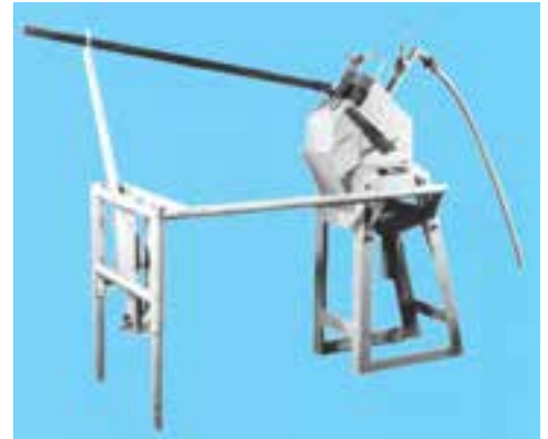
شکل ۸-۱۳- نحوه تیز کردن دکمه‌های سر مته
