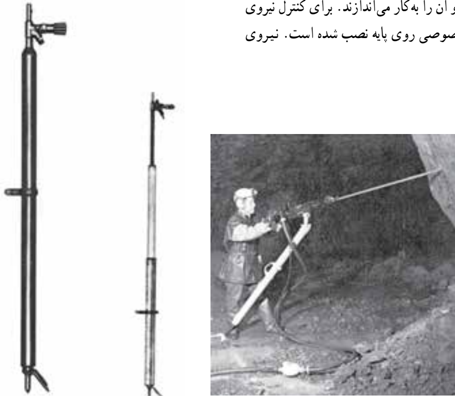
شکل ۲-۷- انواع پایه‌ی انفرادی پنوماتیکی و نحوه‌ی کاربرد با آن
