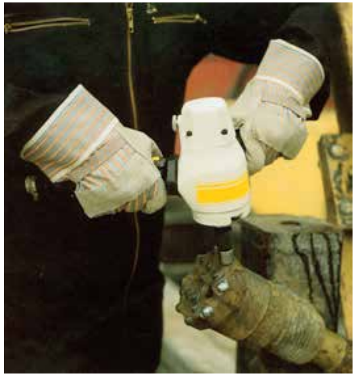
شکل ۸-۱۳- نحوه تیز کردن دکمه‌های سر مته
