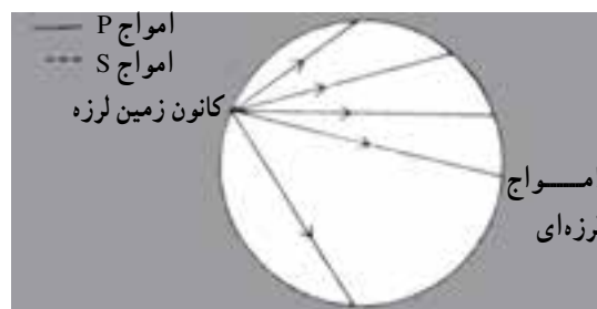
شکل ۱-۶- عبور امواج زلزله در ساختار یک‌نواخت
