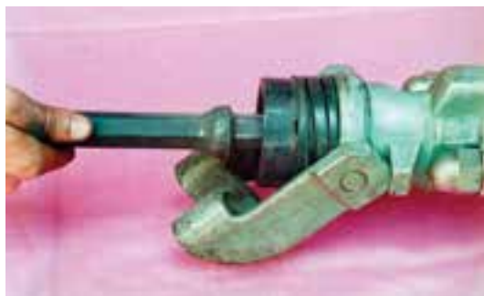
شکل ۷-۴- ته سیلندر پرفوراتور
