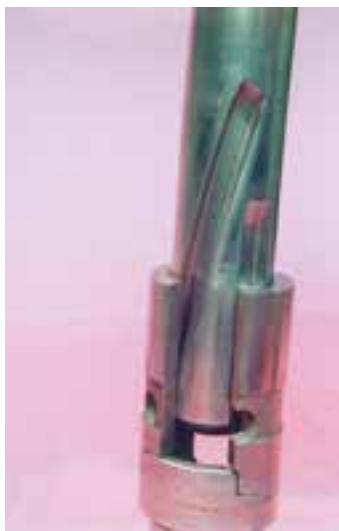
شکل ۲-۴- نحوه‌ی کار پرفوراتور
