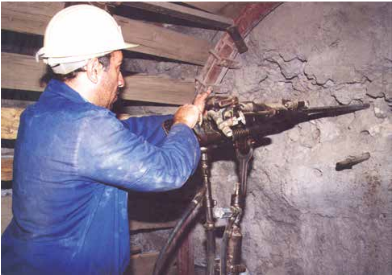
شکل ۲۷-۲- نحوه‌ی به‌کارگیری پرفوراتور
