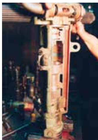
شکل ۲۱-۴- نحوه‌ی جا زدن سرسیلندر
