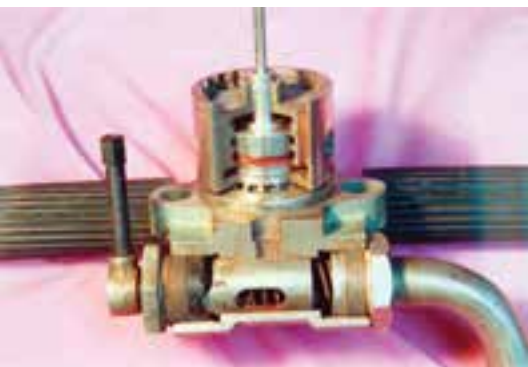
شکل ۵-۴- سر سیلندر و متعلقات مربوطه
