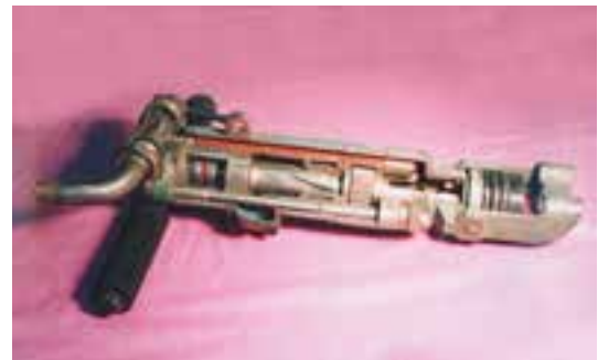
شکل ۳-۴- نمای یک پرفوراتور برش خورده
