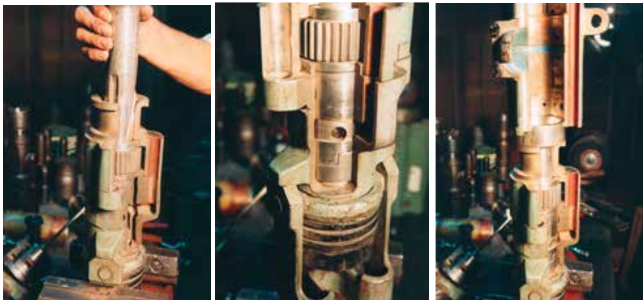
شکل ۱۸-۴- نحوه‌ی جازدن پیستون و پوسته آن
