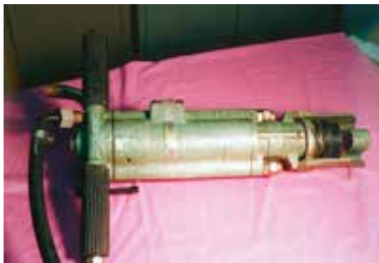
شکل ۲۴-۴- پرفوراتور مونتاژ شده
