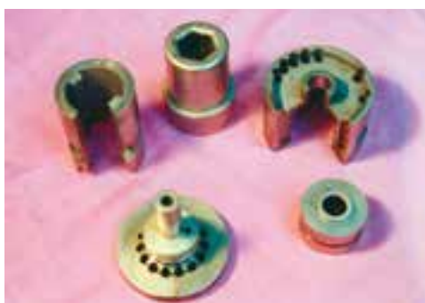
شکل ۶-۴- سوپاپ و پوسته سوپاپ و درپوش سوپاپ
