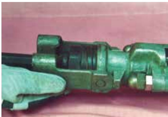
شکل ۲۵-۴- نحوه‌ی تعویض و جازدن مته
