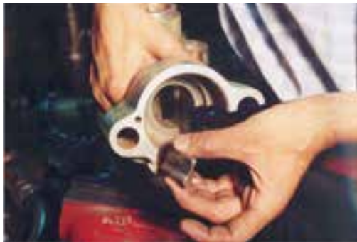
شکل ۱۶-۴- نحوه‌ی جازدن پاول و فنر و ساچمه
