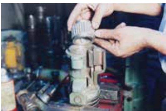
شکل ۱۷-۴- نحوه‌ی جازدن جفجغه
