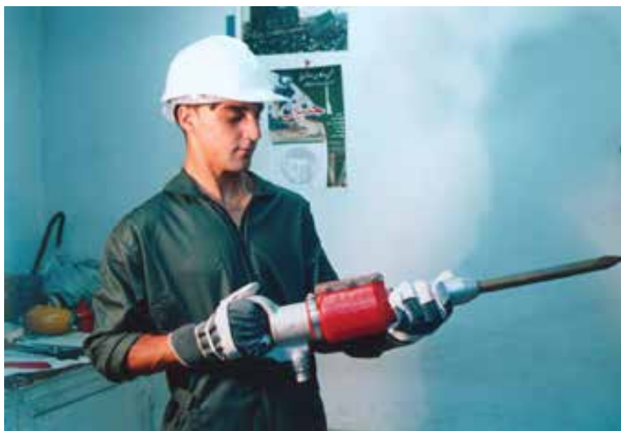
شکل ۳۱-۳- نحوه‌ی به‌دست گرفتن پیکور جهت کار کردن با آن
