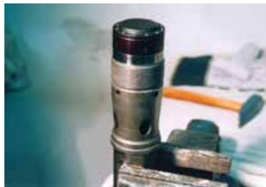
شکل ۲۳-۳- مراحل جازدن درپوش سوپاپ
