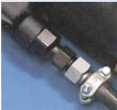
شکل ۳-۴۳- نحوه‌ی بستن پیچ و مهره بست شیلنگ
