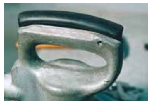
شکل ۱۳-۳- نحوه‌ی جازدن سوزن هوا و دستگیره‌ی لاستیکی
