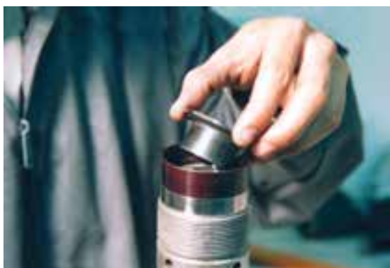
شکل ۳-۲۲- نحوه‌ی جا زدن سوپاپ
