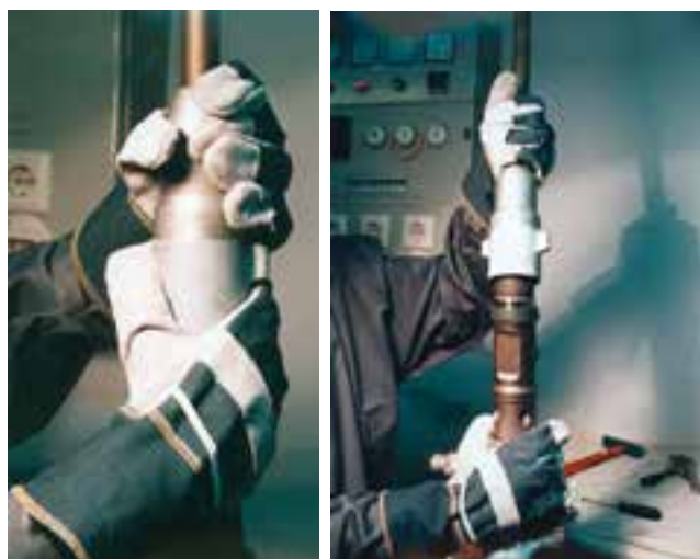
شکل ۲۶-۳- نحوه‌ی بستن ته سیلندر (سرپیک)
