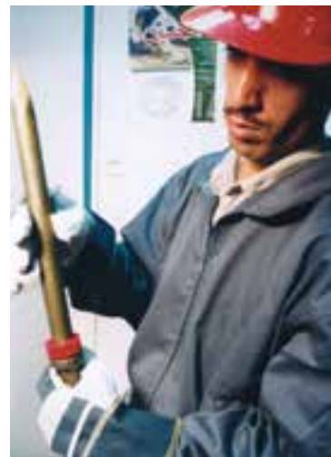
شکل ۲۵-۳- چگونه‌ی جازدن لاستیک ضربه‌گیر و عبور دادن قلم از سریک
