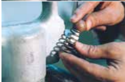
شکل ۱۰-۳- نحوه‌ی جا زدن ساچمه و فنر
