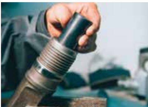
شکل ۱۸-۳- نحوه ی جازدن بیستون
