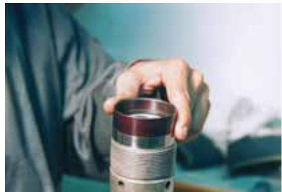
شکل ۳-۲۱- نحوه‌ی جا زدن پوسته‌ی سوپاپ
