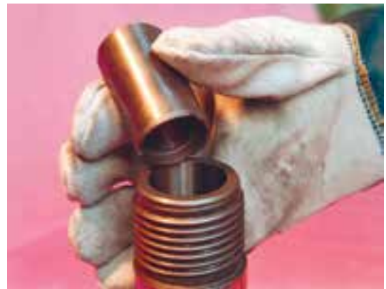
شکل ۱۶-۳- نحوه ی جازدن بوشن قلم گیر پیکور
