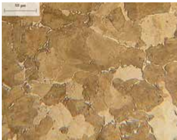
شکل ۲۱-۳ ساختار فولاد یوتکتوئیدی شامل پرلیت \times 550
