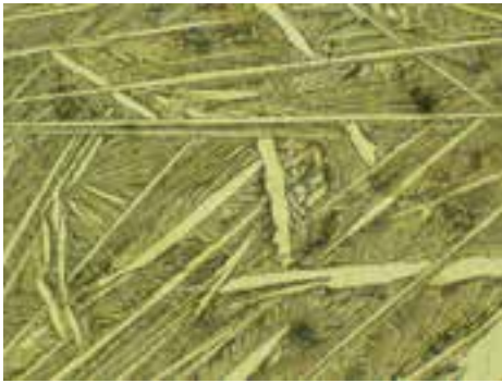
شکل ۲۶-۳ ساختار میکروسکوپی چدن سفید هایپریوتکتیک
