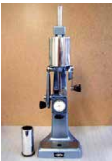
شکل ۸-۱- دستگاه نمونه‌ساز (کوبه‌ی آزمایشگاهی) استاندارد برای آزمایش استحکام ماسه
