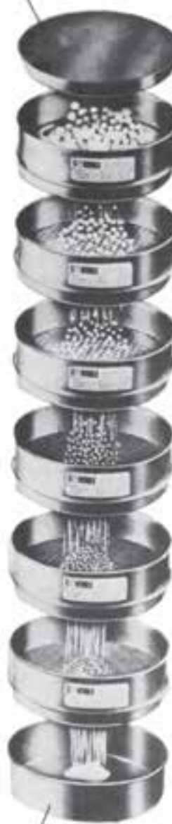
شکل ۱-۳- سری الک ها یا غربال های استاندارد شامل شش الک، یک درپوش و یک کفه
