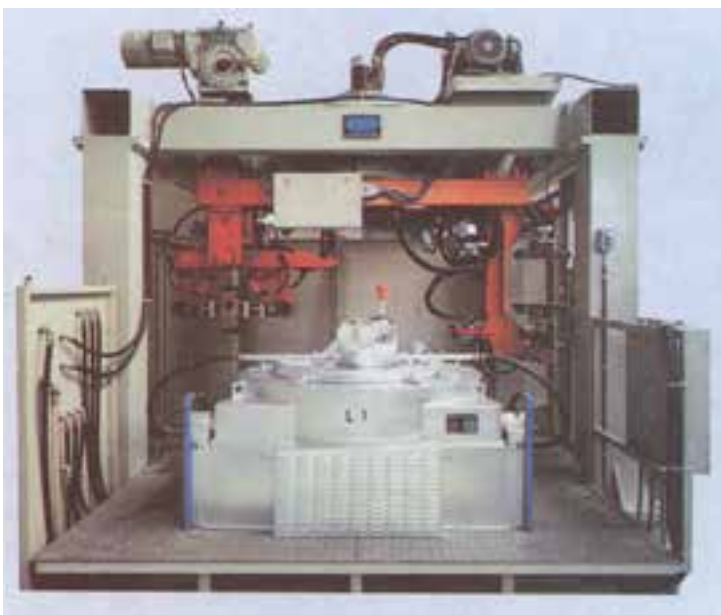
شکل ۱۰-۷- ماشین ریخته‌گری تحت فشار کم
