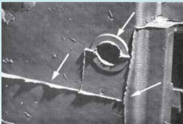
الف — پلیسه به دلیل خوب جفت نشدن و جاگذاری ماهیچه
