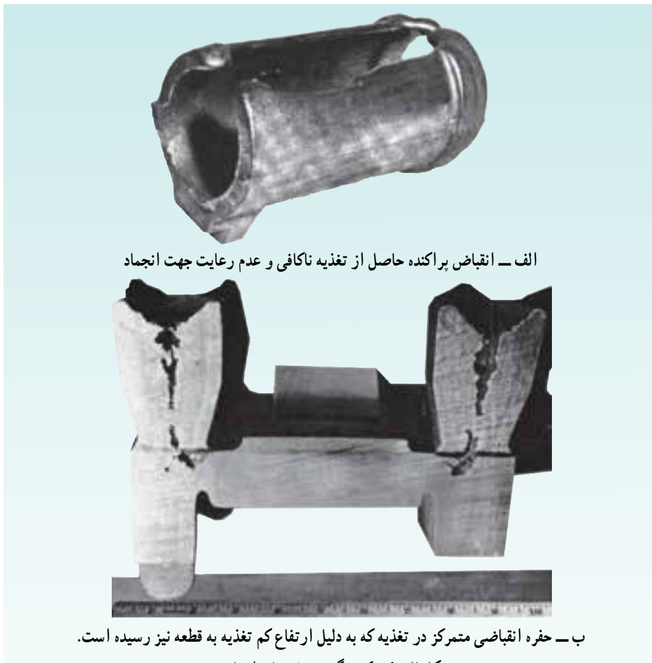
شکل ۲-۹— کشیدگی و حفره‌های انقباضی
