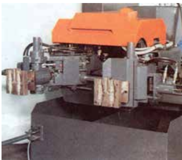
شکل ۳-۷- ماشین ریخته‌گری ریزه تمام اتوماتیک
