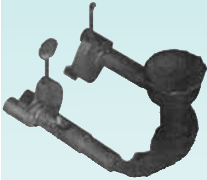
ب — جوشیدن حاصل از سیستم راهگاہی ناصحیح، رطوبت زیاد و هواکش ناکافی
