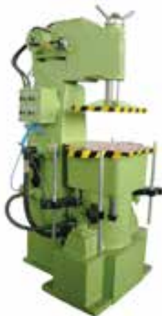
شکل ۶-۷- ماشین قالب‌گیری ضربه‌ای
