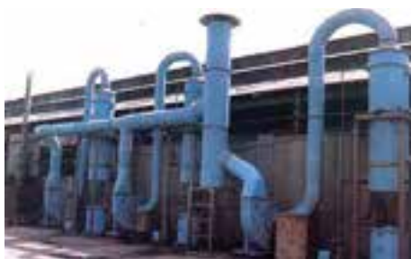
شکل ۵-۳- سیستم سایش نیوماتیکی برای احیای ماسه به روش خشک
