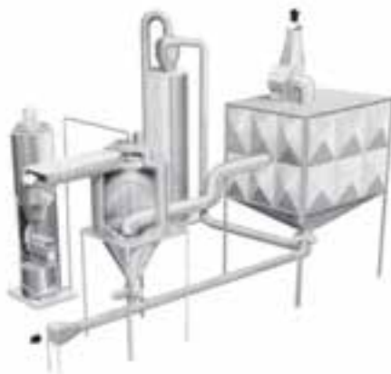
شکل ۵-۳- سیستم سایش نیوماتیکی برای احیای ماسه به روش خشک
