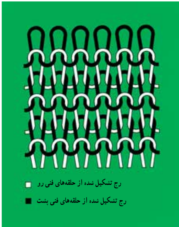
شکل ۱۰-۶- ساختمان بافت ساده دوبله سیلندر
