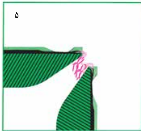
شکل ۱۰-۲- مراحل تشکیل حلقه‌ی بافت در ماشین‌های گردباف دو سیلندر مجهز به سوزن زبانه‌دار
