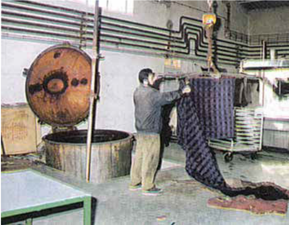
شکل ۳-۱۰- نحوه‌ی قرار دادن پارچه در روی ستاره دستگاه
