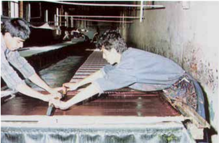
شکل ۱۰-۲- نحوه ی استفاده از راکل یک لبه در کارگاه های چاپ غیر اتوماتیک
