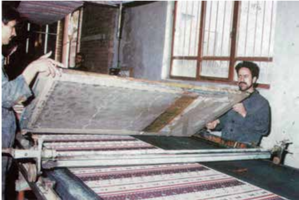
شکل ۲-۱۳- نحوه‌ی قرار دادن شابلون در دستگاه حامل
