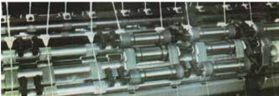
شکل ۱۲-۷- تصویری از سیستم فشار مغناطیسی غلتک‌های کشش
