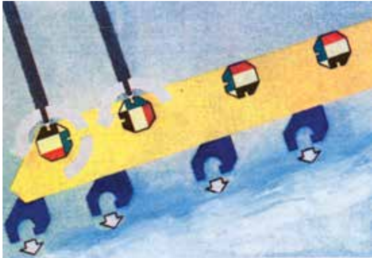
شکل ۱۲-۵- نمایی از قسمت تنظیم فشار روی غلتکهای پایین
