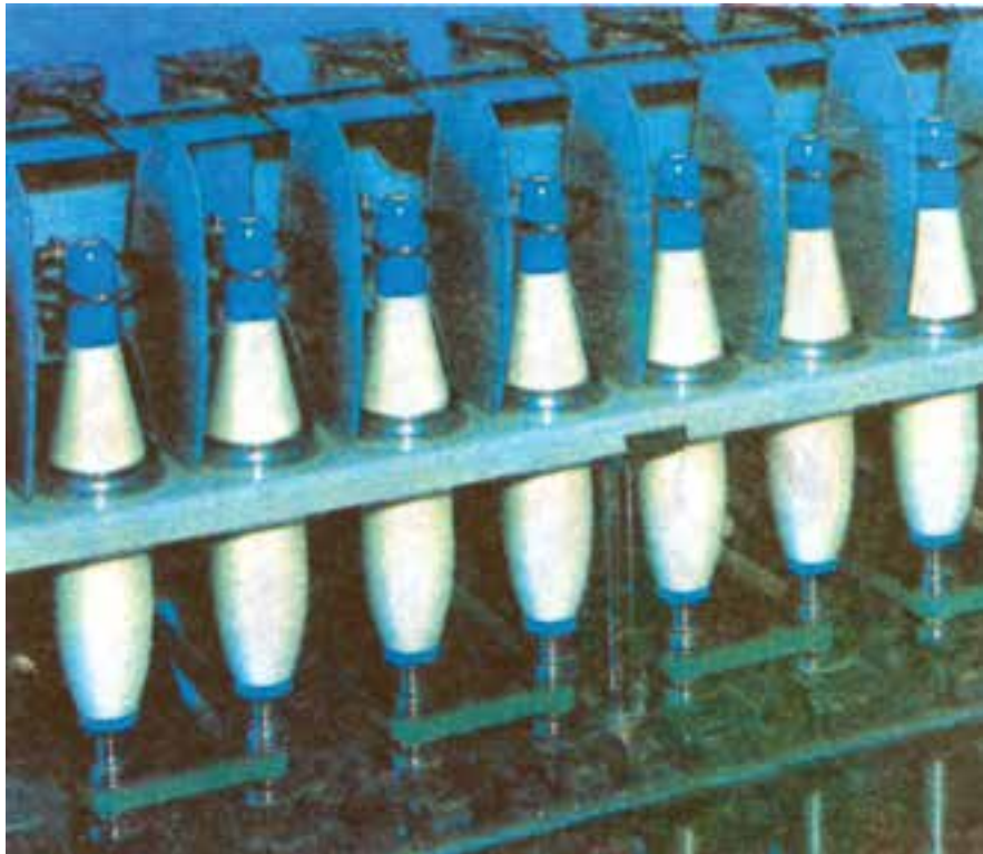
شکل ۹-۶- تصویری از حلقه‌ها و صفحات جداکننده
