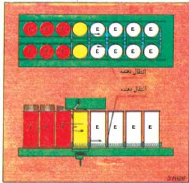
شکل ۱۱-۴ - نمایی از انتقال الیاف از کالندر تا بانک
