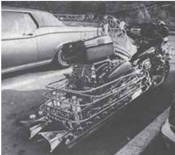
شکل ۱۱-۷- روکش با آب کروم در بعضی از اجزای وسائط نقلیه نوعی حفاظت از خوردگی می‌باشد.
