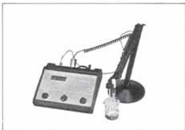
شکل ۲-۱۵- دو نوع pH سنج با دقت 0.1 pH.
