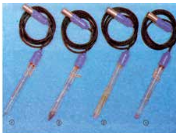
شکل ۳-۱۵- دو نوع pH سنج. الف- با دقت 0.001 pH و ب-
