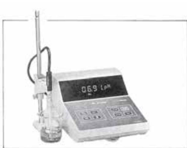
شکل ۲-۱۵- دو نوع pH سنج با دقت 0.1 pH.
