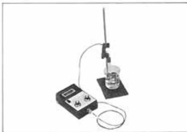
شکل ۲-۱۵- دو نوع pH سنج با دقت 0.1 pH.
