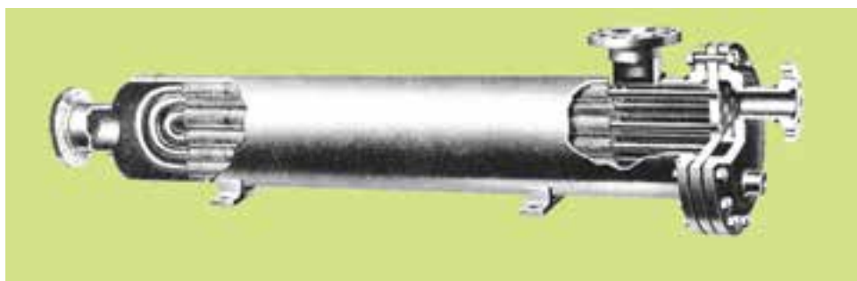
شکل ۷-۴- ساختمان داخلی مبدل‌های حرارتی پوسته - لوله
