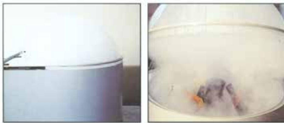
شکل ۱-۱۳- دستگاه تولید مه نمک (سالت اسپری Salt spray) مورد استفاده: بررسی مقاومت فیلم خشک رنگ در محیط‌های خوردنده نمکی
