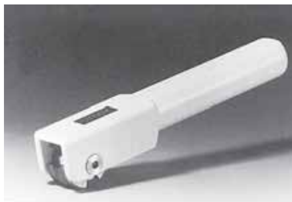
شکل ۱۳-۱۲- کاتر مخصوص اندازه‌گیری چسبندگی به روش صلیبی
