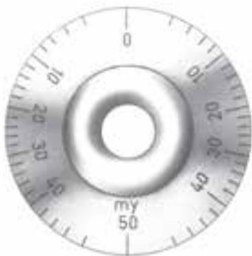
شکل ۹-۱۳- ضخامت سنج فیلم خشک رنگ (روش تخریبی)
