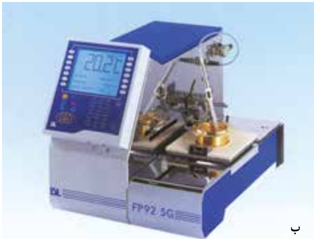
شکل ۲-۴- «ظرف درباز کلیولند» الف) دستگاه قدیمی ب) دستگاه جدید (اتوماتیک)
