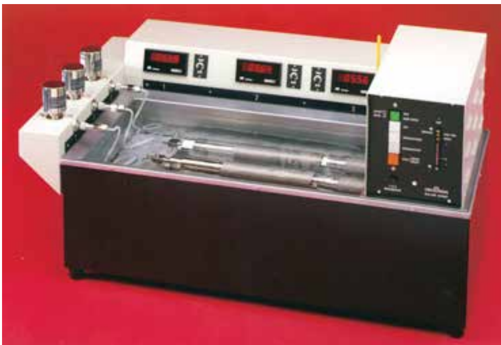
شکل ۳-۵- دستگاه اندازه‌گیری فشار بخار: نمونه و محفظه‌ی هوا در داخل حمام سرمایش قرار دارند.
