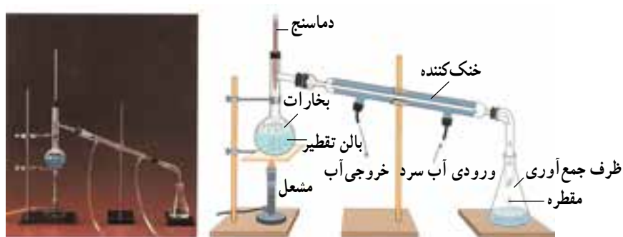
شکل ۱-۵ نمایشی از دستگاه تقطیر آزمایشگاهی
