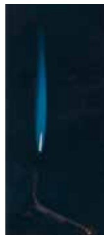
ت) یک مشعل متان - اکسیژن که می‌تواند شیشه‌هایی از جنس کوارتز را که دمای ذوب آن‌ها در حدود 1600^{\circ}\text{C} است ذوب کند.
