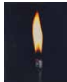
ب) یک چراغ پونزن با شعله زرد که در آن واکنش سوختن گاز کامل نیست.
