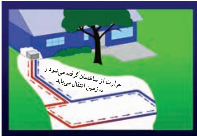
شکل ۳-۷ چگونگی کار پمپ حرارتی در تابستان
