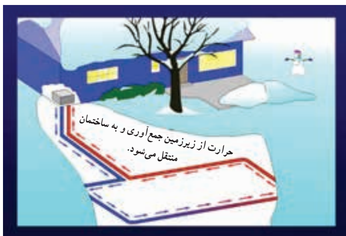
شکل ۶-۳ چگونگی کار پمپ حرارتی در زمستان
