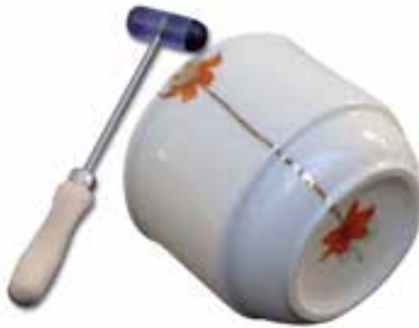
شکل ۴-۲- یکی از روش‌های ساده برای کنترل ترک‌خوردگی در ظروف چینی (استفاده از چکش لاستیکی مخصوص)
