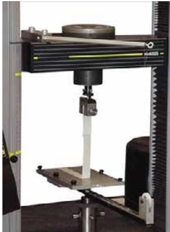
شکل ۲-۲- دستگاه پیشرفته اندازه‌گیری میزان چسبندگی انواع نوارها
