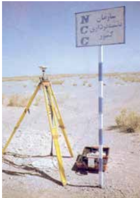
شکل ۱۱-۷- یک نقطه‌ی تراز یابی به نام AQAR1086 در منطقه‌ی امام‌زاده هاشم را نشان می‌دهد که دستگاه GPS روی آن مستقر شده است.
