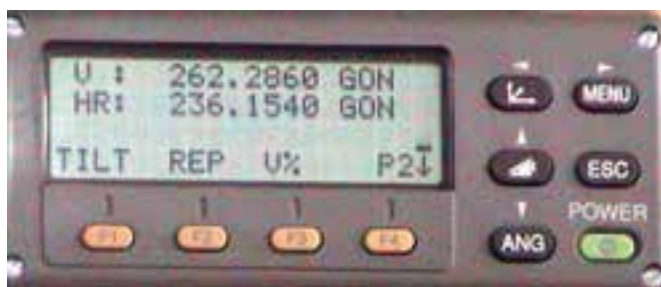
▲ شکل ۶-۶- صفحه دوم منوی زاویه در توتال استیشن تاپکن سری GTS-۲۲۰
