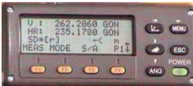
▲ شکل ۶-۸- صفحه اول منوی طول یابی در توتال استیشن تاپکن سری GTS-۲۲۰
