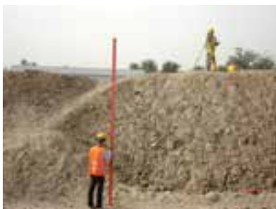
▲ شکل ۱-۶ برداشت به روش تاکنومتری با دوربین ترازیب دیجیتال
