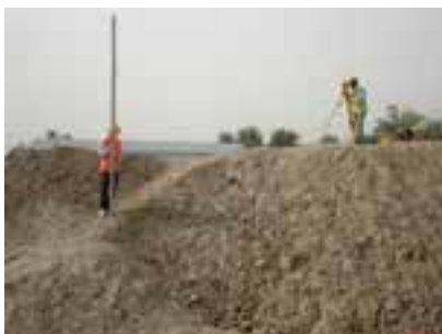
▲ شکل ۱-۶ برداشت به روش تاکنومتری با دوربین ترازیب دیجیتال
