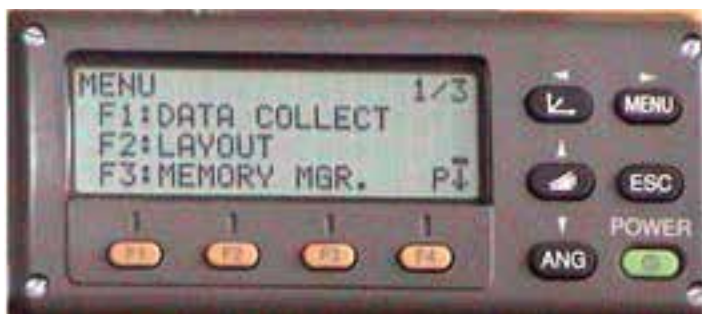
▲ شکل ۶-۱۴- ورود به منوی DATA COLLECT
