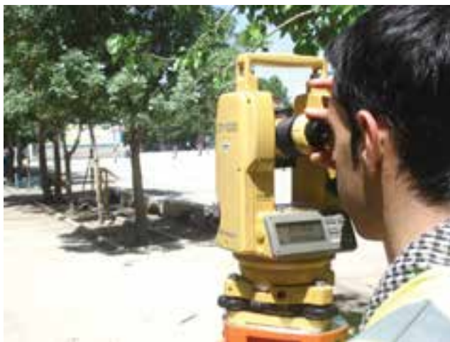
▲ شکل ۵-۳- هنگام شروع عملیات زاویه‌خوانی، دوربین در حالت دایره به چپ باشد.
