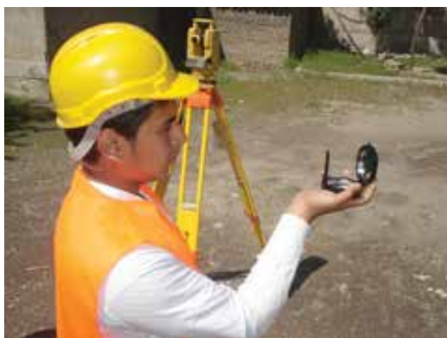
▲ شکل ۴-۲- اندازه‌گیری آزمون رؤس چندضلعی به کمک قطب‌نما
