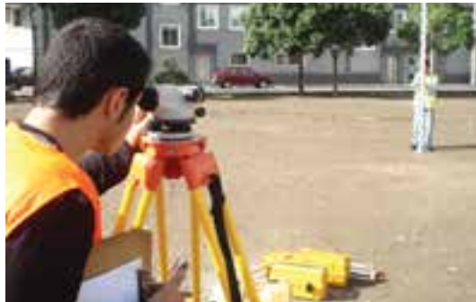
▲ شکل ۳-۲- فاصله‌یابی به روش استادیمتری
