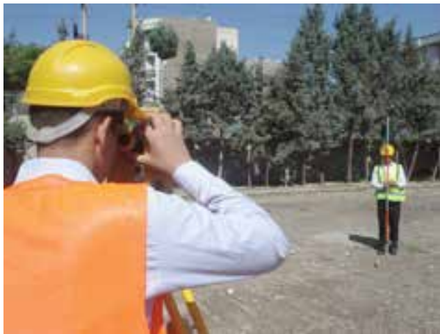
▲ شکل ۴-۳- برداشت زاویه و ژیزمان یک امتداد
