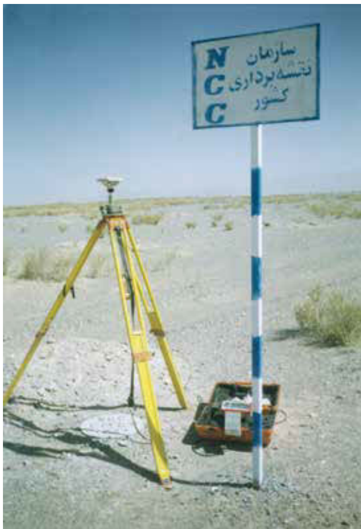
شکل ۳-۴ - یک نقطه‌ی ترازیبی به نام AQAR1086 در منطقه‌ی امام زاده هاشم را نشان می‌دهد که دستگاه GPS روی آن مستقر شده است.
