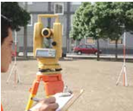
الف) نشانه روی و قرائت امتداد سمت چپ در حالت دایره به ب) نشانه روی و قرائت امتداد سمت راست در حالت دایره به چپ دوربین
