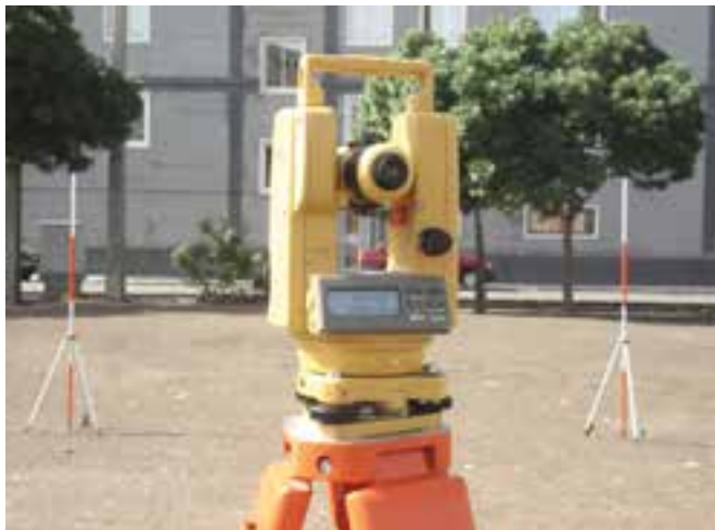
▲ شکل ۲-۱۵- نشانه‌روی و قرائت با زاویه‌یاب دیجیتال
