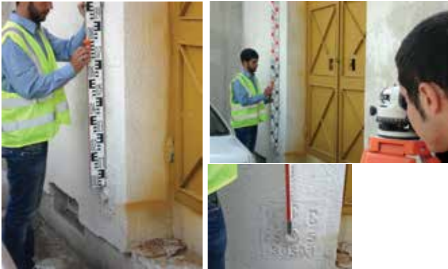
▲ شکل ۱-۱ – ترازبایی از یک نقطه پنج مارک
