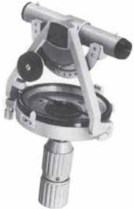
شکل ۵-۱- انواع قطب‌نماهای کامل نقشه‌برداری
