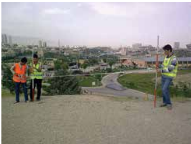
شکل ۴ - ۲. خطای افقی نبودن متر
