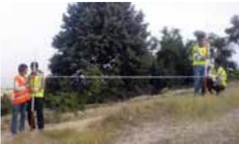
شکل ۲-۹. مترکشی افقی به صورت صحیح
