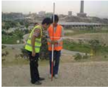
شکل ۲- ۱۴. زاویه صحیح قرائت متر
