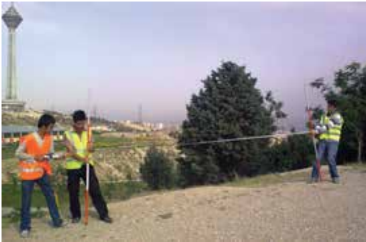
شکل ۲- ۱۱. کشش نامناسب متر
