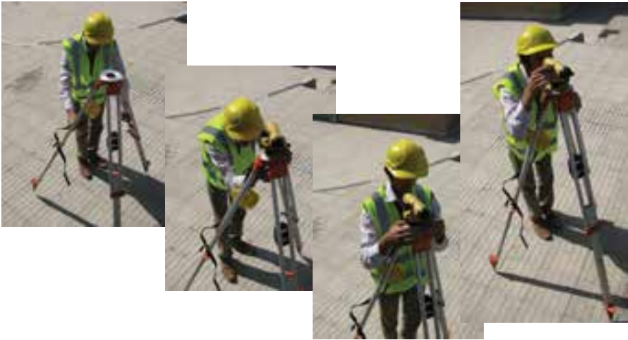
شکل ۱۱ - ۷. مراحل استقرار دوربین تراز یاب
