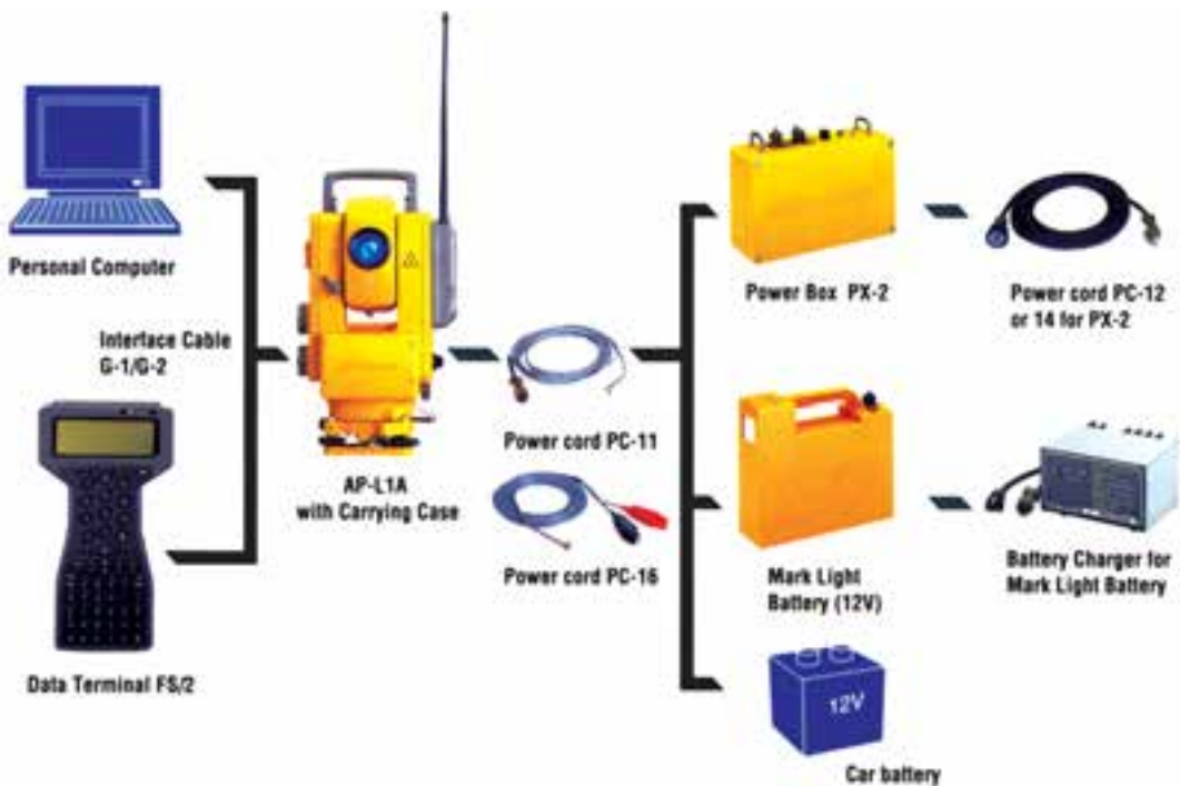
شکل ۲۲-۴- نمایش ارتباط توتال استیشن با تجهیزات جانبی
