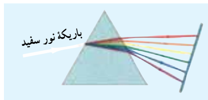
شکل ۵-۱۵- پاشیدگی نور سفید در عبور از منشور
