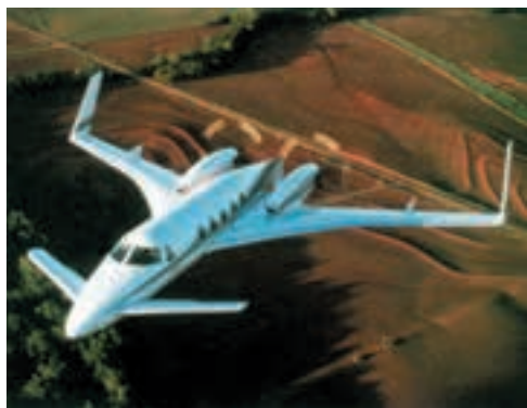
بدنه‌ی هواپیماهای جاسوسی را از چندسازه‌ها می‌سازند. زیرا، چند سازه‌ها موج‌های فرستاده شده از رادار را جذب می‌کنند و در آن دیده نمی‌شوند.
