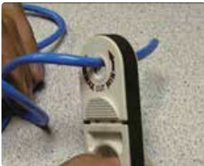
شکل ۴۴-۴- روکش‌برداری از کابل شبکه
