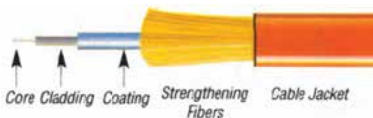
شکل ۸-۴- اجزای تشکیل‌دهنده یک کابل فیبر
