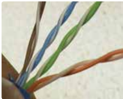
شکل ۴۴-۴- روکش‌برداری از کابل شبکه
