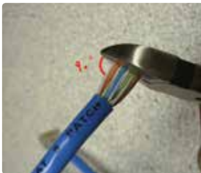
شکل ۴۵-۴- برش سیم‌های کابل شبکه
