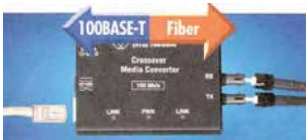
شکل ۱۷-۴- مبدل فیبر نوری به سوکت RJ45
