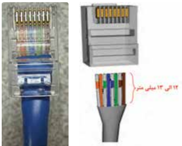
شکل ۴۶- سوکت زدن به سر کابل
