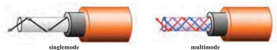
شکل ۱۱-۴- فیبر تک حالت و چند حالت
