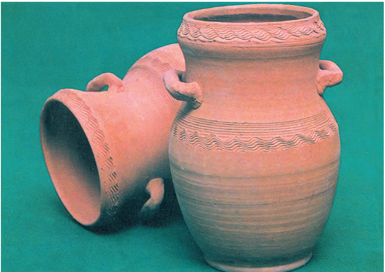
تصویر ۱۵۲- سفال بدون لعاب - روش ساخت: چرخ کاری
