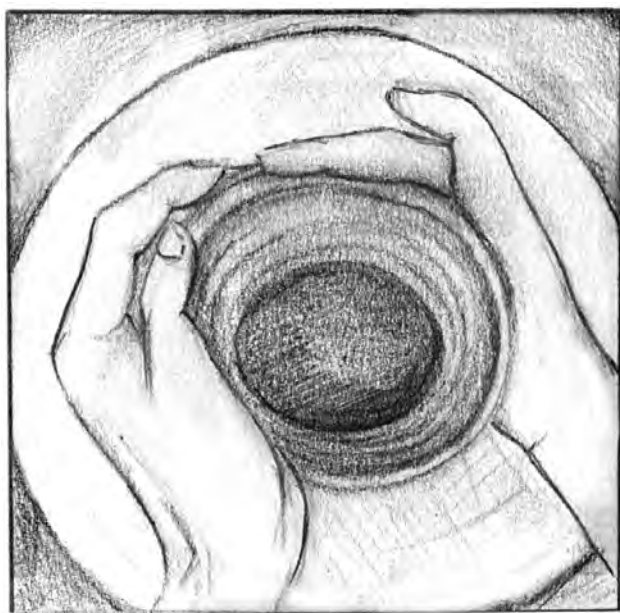
تصویر ۱۴۶- طریقه شکل دادن به دیواره طرف
