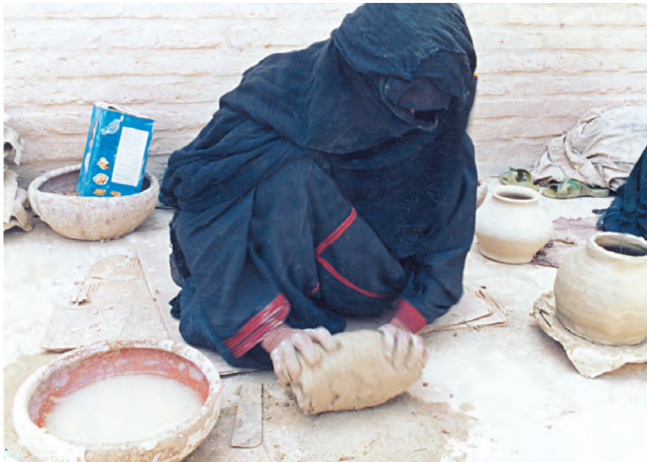
تصویر ۱۵۰- زن سفالگر در حال شکل دادن به گِل با دست - کلبورگان
