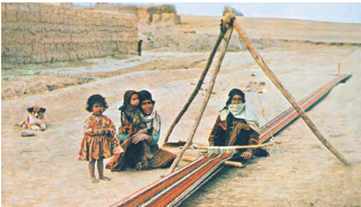
تصویر ۳۲- دستگاه جاجیم بافی سنتی در دست زن ایل سون هشترود
