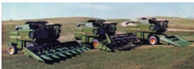
شکل ۲۰-۴- سه نوع دماغه متصل به کمباین برای محصولات مختلف
