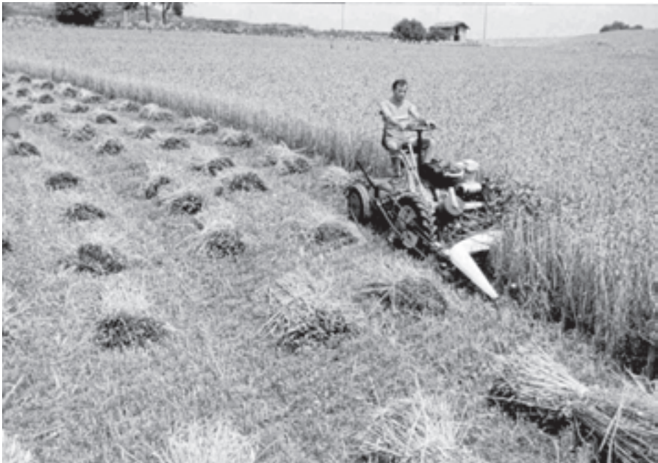
شکل ۴-۱۶- دروگر دسته‌بند در حین کار
