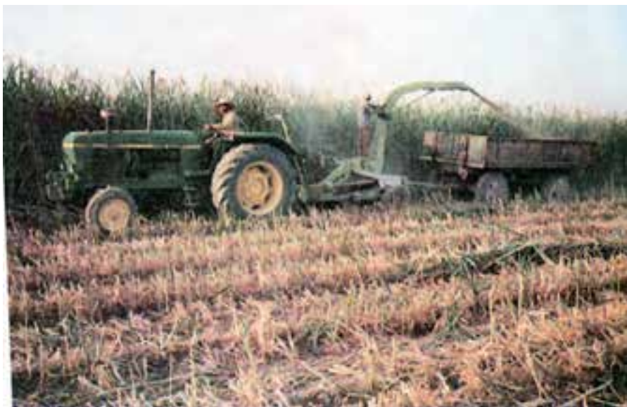
شکل ۱۹-۲- عملیات برداشت ذرت علوفه‌ای با چاپر
