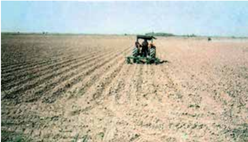
شکل ۱۳-۲ - دستگاه ردیف‌کار ذرت در حال کاشت ردیفی
