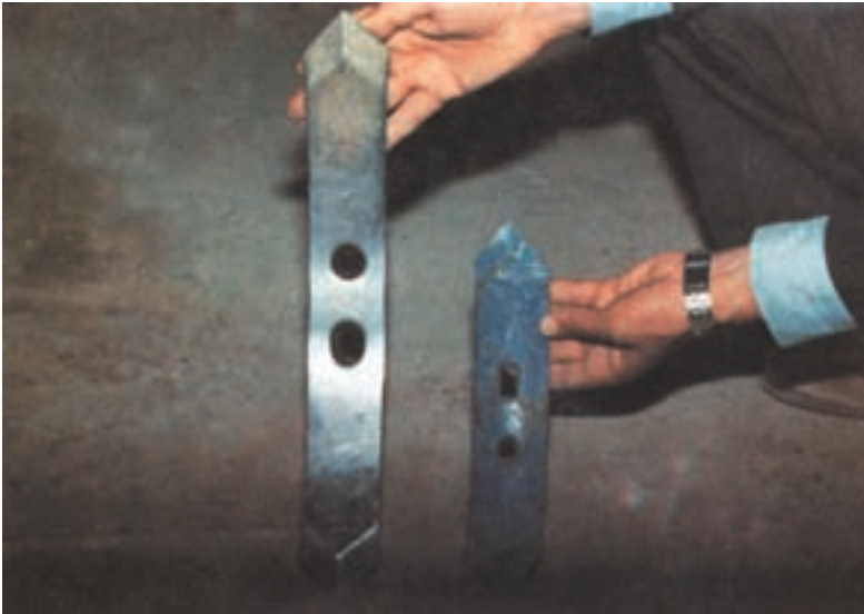
شکل ۳-۶ - انواع تیغه‌های گاو آهن قلمی (چیزل)
