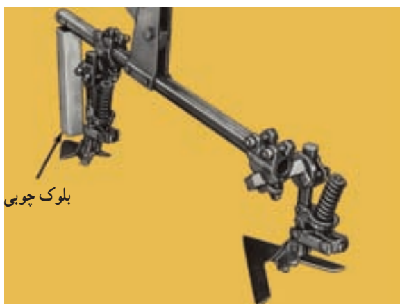
شکل ۱۲-۳- استفاده از قطعه چوب برای تراز پنجه
