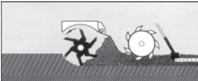
شکل ۲۳-۲- ماشین کمبینات (خاک‌ورزی کاشت توأم)
