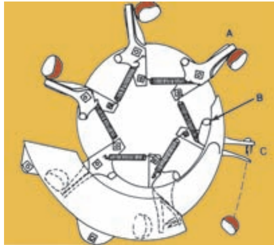
شکل ۱۸-۲- موزع سیبزمینی از نوع چنگک‌دار
