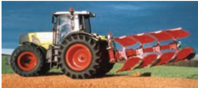
شکل ۳-۱- گاو آهن برگردان دار دو طرفه
