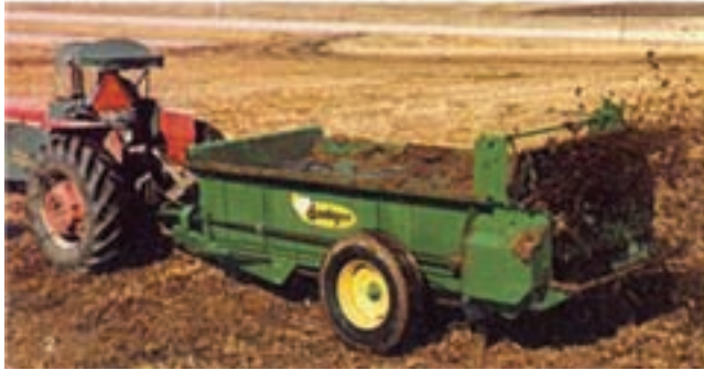
شکل ۳۸-۱- کودپاش کود دامی جامد در حین کار
