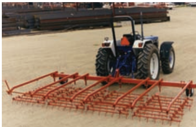
شکل ۱-۳۰- اتصال چند قاب به مالبند
