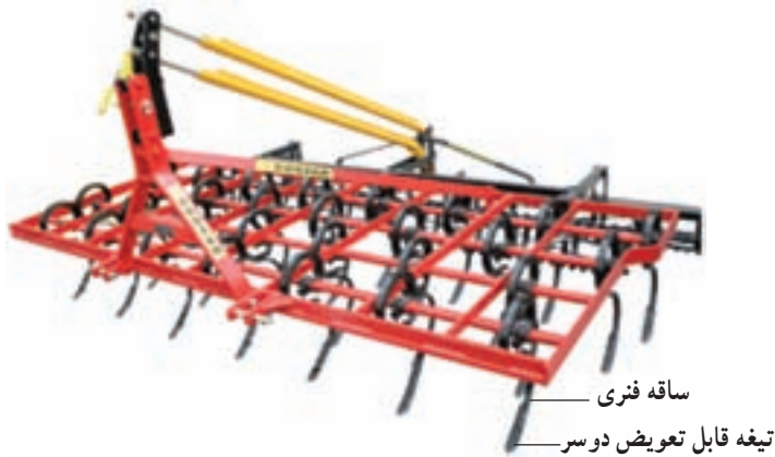
شکل ۲۸-۱- پنجه با ساقه فتری
