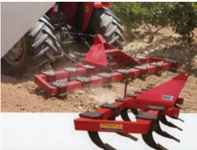
شکل ۱-۱۸- یک گاو آهن زیرشکن چندساقه‌ای
