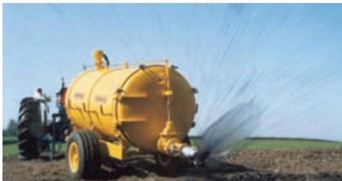
شکل ۱-۳۷- یک نوع کودپاش کود دامی مایع
