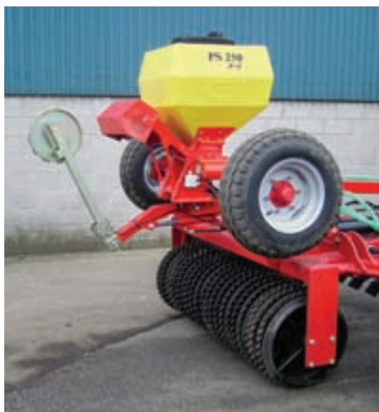
ب- غلتک کمبریج بر روی ماشین مرکب
