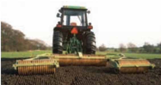
شکل ۳۴-۱ نحوه اتصال چند گروه غلتک حلقوی
