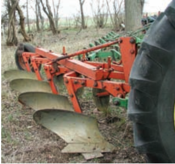
شکل ۲-۱- گاو آهن برگردان دار یک طرفه
