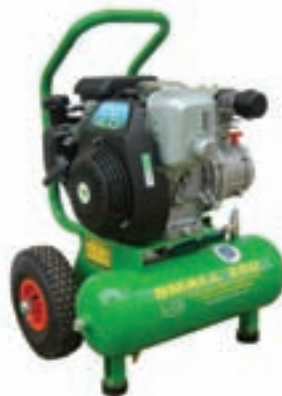
الف - پمپ باد چرخدار کوچک با موتور بنزینی
