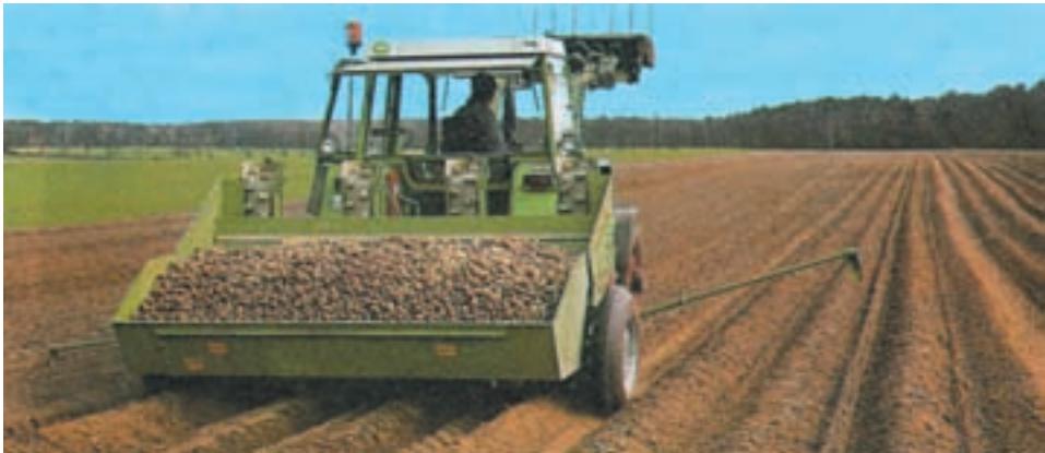
شکل ۱-۶- سیب‌زمینی کار چهار ردیفه در حال کاشت
